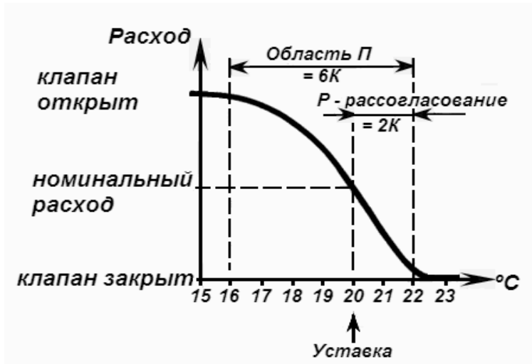
Рисунок 7.4 – Идеальная характеристика термостатического вентиля (гистерезис не показан, \Delta P = 0,1 – постоянное)
