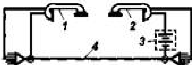
Рисунок 7.45 – Схема прозвонки кабеля с помощью телефонных трубок
