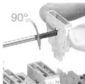
Рисунок 7.31 – Установка электронного компонента в универсальной штекерной зоне клемм.
