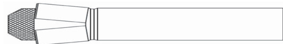
Рисунок А.8 – Анкер с контролируемым перемещением
