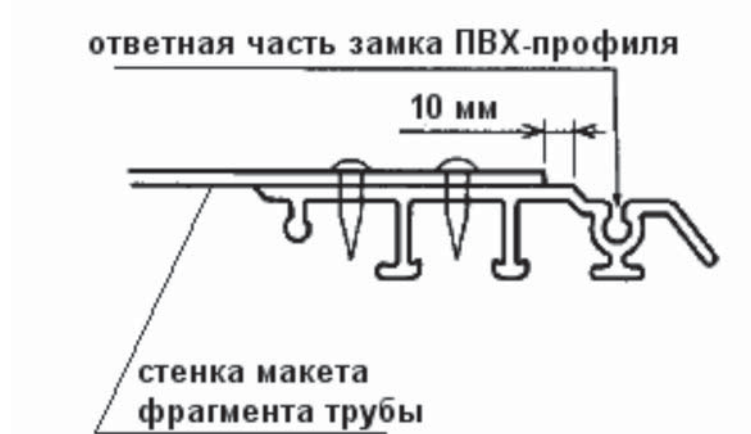
Рисунок 6 – Фиксация кольца из ПВХ-профиля в макете фрагмента трубы
