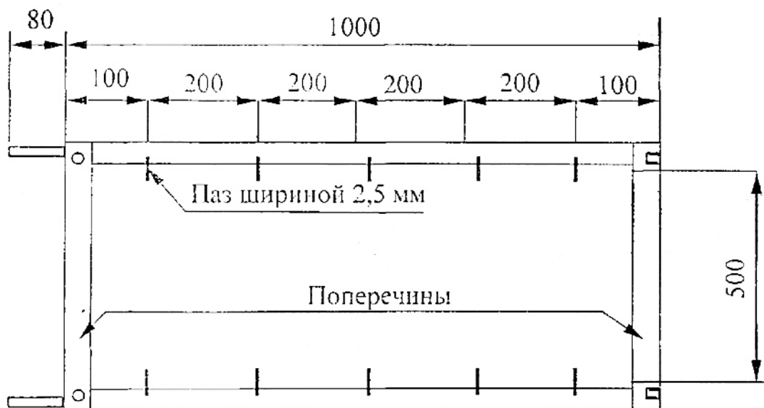
Рисунок М.2 – Рамка шаблона (размеры указаны в мм)
